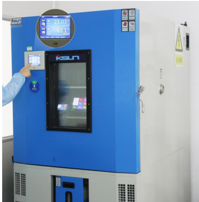
图 6-7 高低温老化测试图
